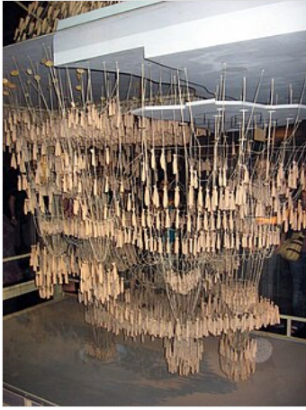
An upside-down force model of the Colònia Güell, Sagrada Família Museum
